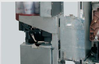
Distribuidor de vasos con apertura doble para una completa articulación del conjunto, facilita el acceso a la parte interior de la máquina en las operaciones de carga, mantenimiento y limpieza
